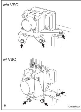
(d) Remove the 3 bolts and brake actuator with the bracket.
