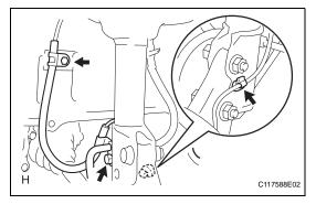
(d) Remove the bolt and speed sensor.
