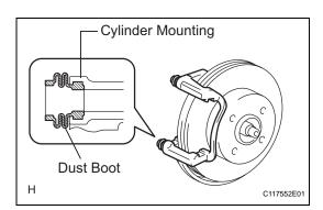
8. REMOVE FRONT DISC BRAKE DUST BOOT
